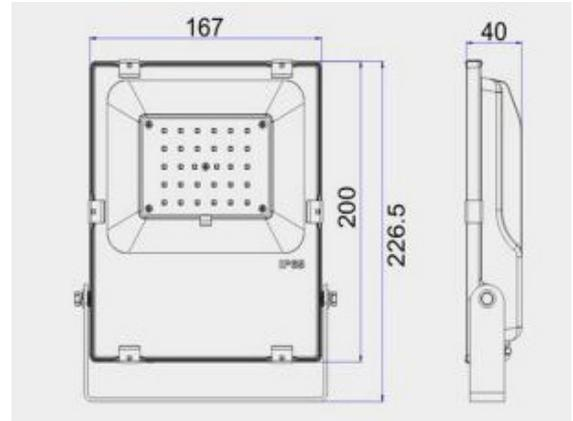
Strahler für den Außenbereich LED aus Aluminium Druckguss, echtglas Frontscheibe 120 Grad Abstrahlung. Kein Kunststoffteil angebaut. Eignet sich hervorragend für die allgemeine Ausleuchtung von Flächen und Hallen. Die durch die geringe Höhe hat der Strahler ein sehr unscheinbares Erscheinungsbild und sehr wenig Wärmeentwicklung.
